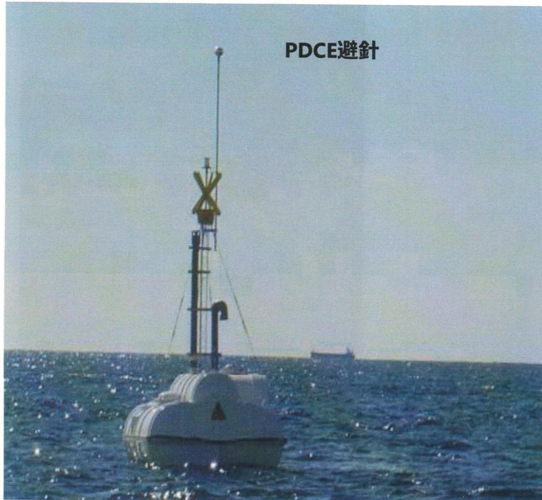
波力発電装置への落雷防止
