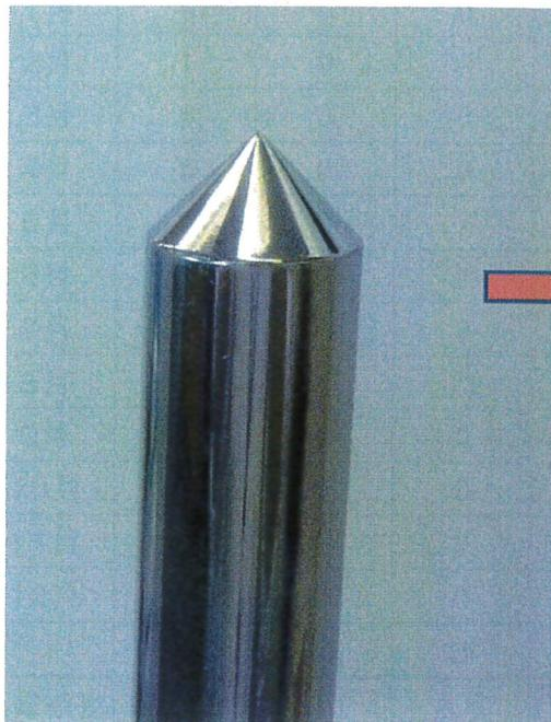
2冬を越して8回の雷擊で先端部分は溶けだし
