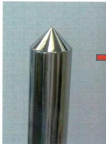
2冬を越して8回の雷撃で先端部分は溶けだしてイボが生成している(冬季雷の特徴)
