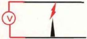
落雷の確率が50%になるように電圧を設定
