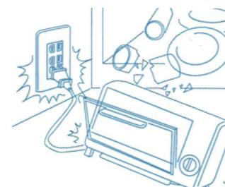
電源が入った状態の電気製品等が転倒・落下して生ずる火災。
